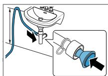
Обезопасете местата на свързване със скоба за маркуч (12-22 mm).
