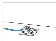
Избутайте маркуча за мръсната вода напълно през и фиксирайте с крепежен материал. Закрепете дръжката върху канала.
